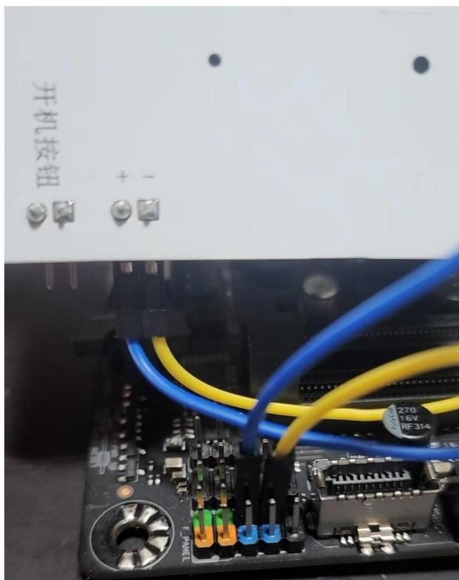
4. 如果您的机箱有开机按钮，请连接至开机卡标有“开机按钮”的接针上
